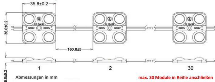
max. 30 Module in Reihe anschließen
